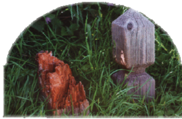
左はカナダのファミリーが12年間の野外埋杭をした結果（カルガリー、カナダ）右は、上の杭をカットした断面
