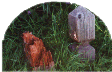
左はカナダのファミリーが12年間の野外埋杭をした結果（カルガリー、カナダ）右は、上の杭をカットした断面
