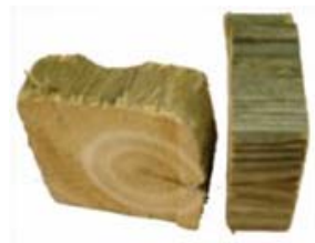
左はカナダのファミリーが12年間の野外埋杭をした結果（カルガリー、カナダ）右は、上の杭をカットした断面
